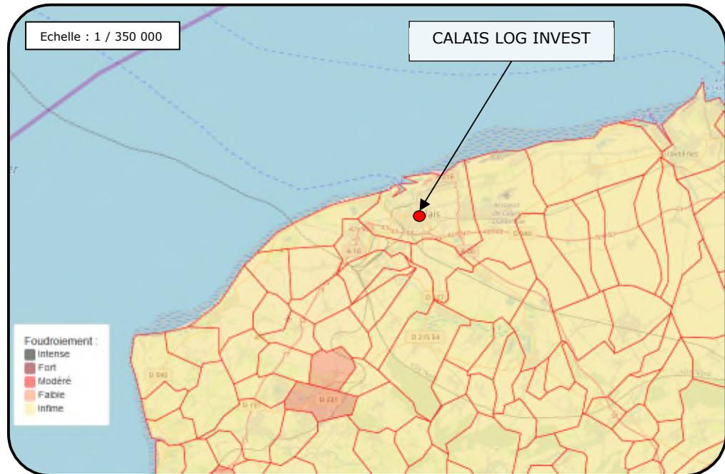
La sensibilité d'un site vis-à-vis de la foudre est évaluée par la densité de foudroiement  $N_g$ . Cette variable est exprimée en nombre d'impacts de la foudre par an et par  $\text{km}^2$ . Le relevé est effectué à l'aide d'un réseau de stations de détection qui captent les ondes électromagnétiques lors des décharges, les localisent et les comptabilisent.
